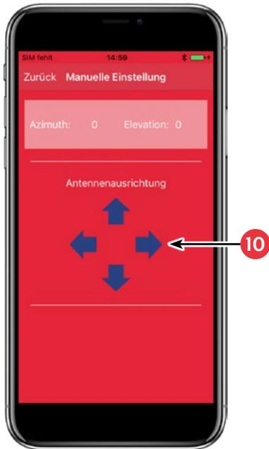
10. Drehen Sie im Menü „Manual Adjustment“ die Antenne mit den Pfeilen nach links und rechts für den Azimut (Drehung), oder drehen Sie die Antenne mit den Pfeilen nach oben und unten für die Elevation (Neigung).
