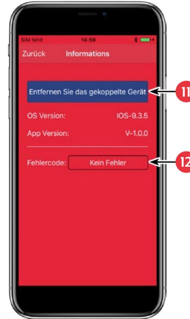
11. Wenn Sie die App mit dem Steuergerät trennen möchten, drücken Sie dieses Feld. Anschließend können Sie sich mit einem anderen bzw. neuen Steuergerät koppeln.
