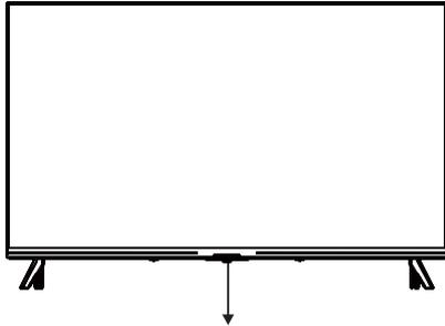
Drücken Sie diese Taste im Standby-Modus, um das Fernsehgerät ein- bzw. auszuschalten.
